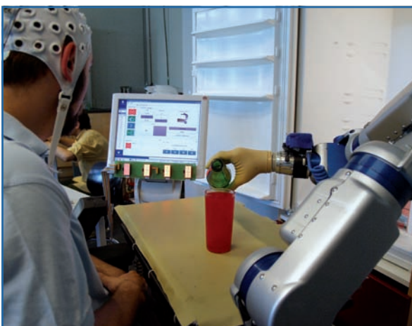
Abbildung 2: Rehabilitationsroboter mit Brain-Computer-Interface
